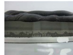
Bild 7 Haftverhalten Glas – Dichtstoff
