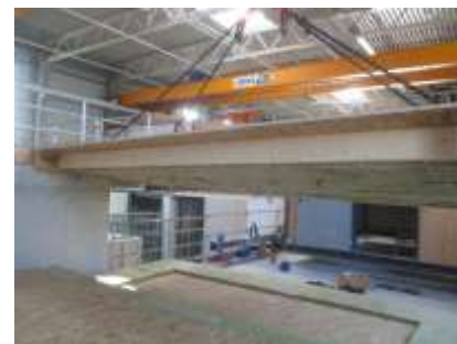
Deckenprüfung im ift-Bauakustiklabor
