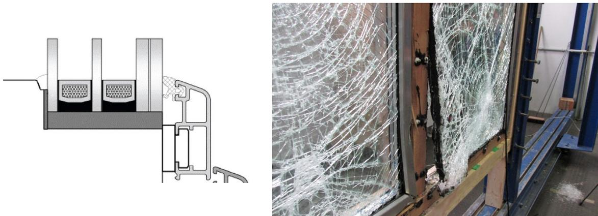
**Bild 2** Beispiel Holz-Aluminiumfenster mit voll ausgefülltem Glasfalzgrund;
