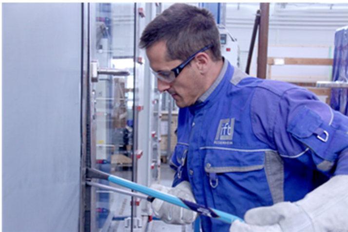
Bild 1 Einbruchprüfung am ift Rosenheim
