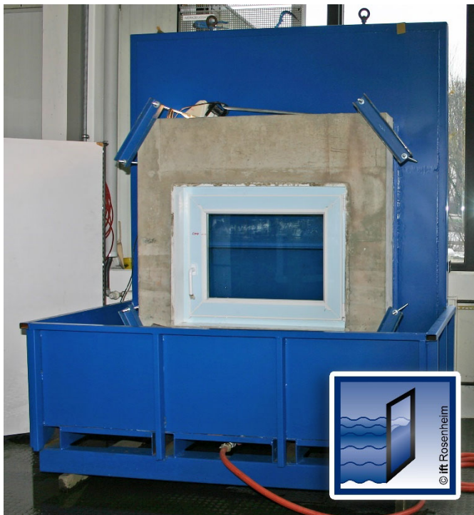
Bild 1 Prüfung des Schutzes gegen Hochwasser nach ift-Richtlinie FE-07/1, Kellerfenster (Quelle: ift Rosenheim)
