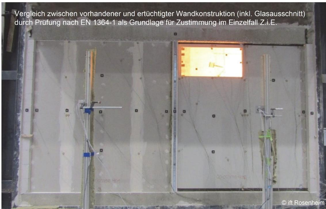
**Bild 4** Brandprüfung der nachgebauten bestehenden Wand (links) und einer modifizierten Wandkonstruktion (rechts mit neuem Glasausschnitt) nach EN 1364-1 zur Bewertung und als Nachweis des geforderten Feuerwiderstands. (Quelle: ift Rosenheim)
