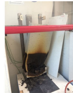
80. Minute Thermische Zersetzung Probekörper
