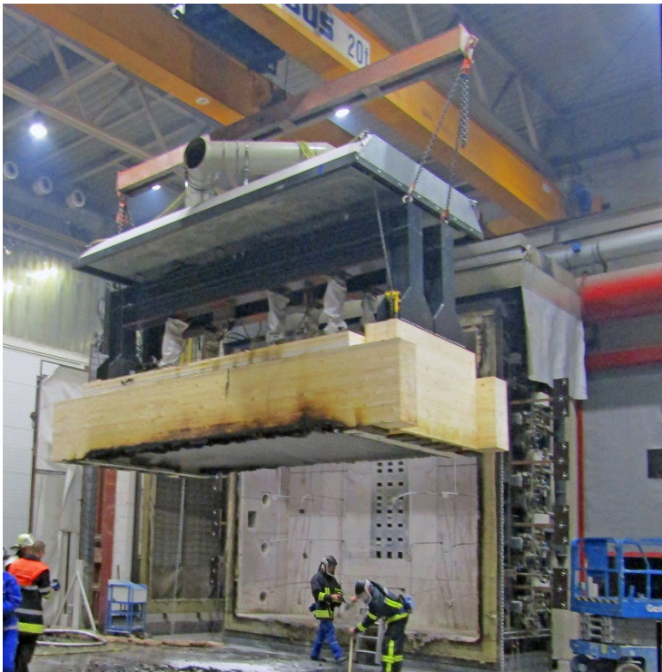
Bild 1 Brandprüfung einer tragenden Holzbalkendecke mit Holzverbindern im Auftrag der Universität Innsbruck
