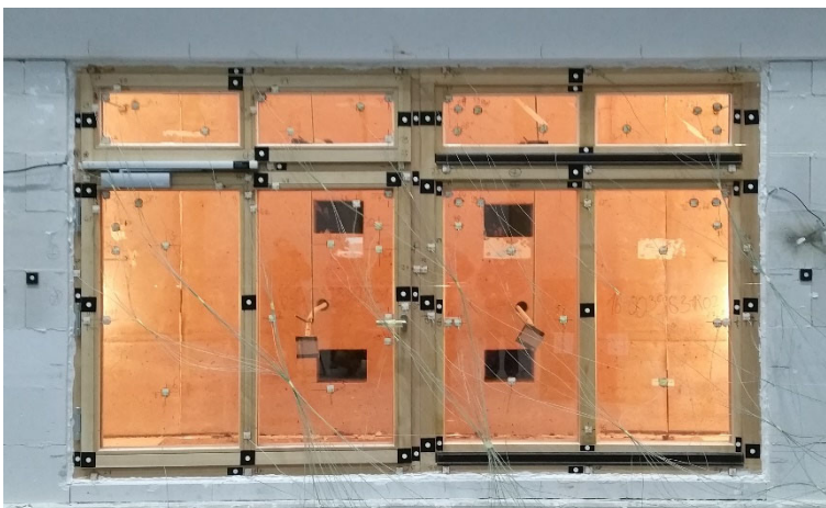
Bild 3 Zwei gekoppelte einflügelige Fenster
