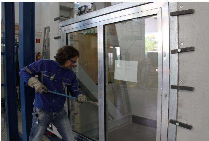
Bild 4 Fenster bei der manuellen Einbruchprüfung im ift Rosenheim
