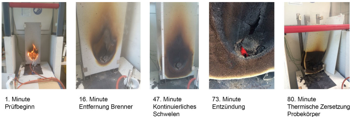
Bild 1 Prüfung des Schwel- und Glimmverhaltens nach DIN EN 16733 am Beispiel eines 100 mm dicken Baustoffs für Schallabsorber. Versagenskriterium ist das anhaltende Schwelverhalten mit Selbstentzündung bei Minute 73 und anschließender thermischer Zersetzung des Probekörpers. [5]
