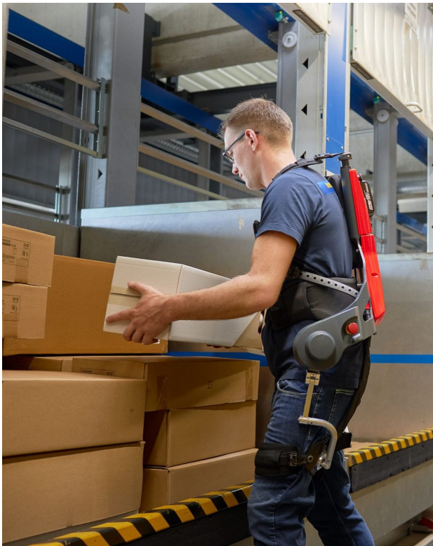
Bild 8 Exoskelette für die Industrie und Logistikbranche machen große Fortschritte und sind bald für Montagesituationen einsetzbar. (Bild: GBS German Bionic Systems GmbH)
