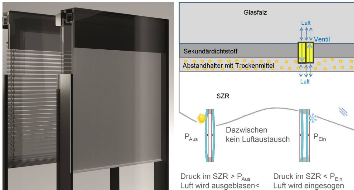
Bild 8 Druckentspanntes Isolierglas mit innenliegendem Sonnenschutz (Iconic Skin [8])
