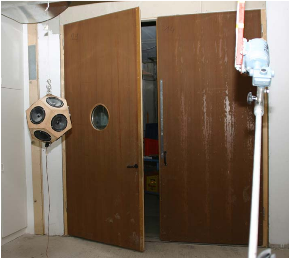
Bild 1 Schallprüfung einer zweiflügeligen Innentür im ift-Labor Bauakustik
