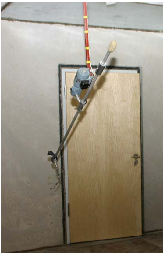
Bild 2 Schallprüfung einer Innentür im ift-Labor Bauakustik
