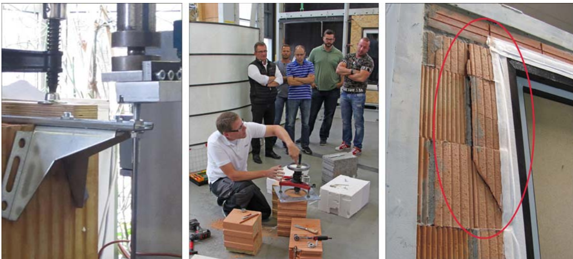
Bild 7 Demonstration von Prüfungen zur Tragfähigkeit und Auszugsfestigkeit von Konsolen und Befestigungsmitteln im Weiterbildungsseminar zur ift-Fachkraft Montage
