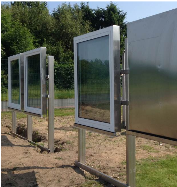
Bild 1 Fensterelemente in der Freibewitterung
