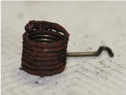
Bild 4 Korrodierte Feder führte infolge von Bruch zum Ausfall des Motors
