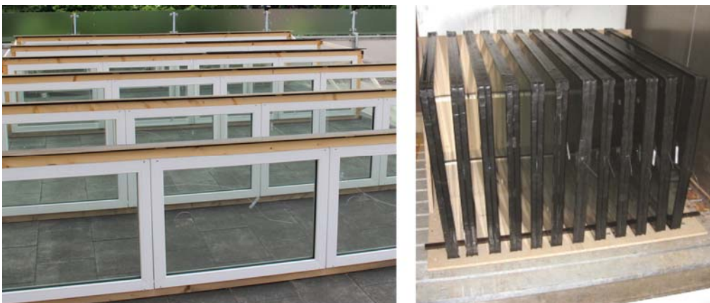
Bild 6 Probekörper in der Freibewitterung (links) und in der Klimakammer (rechts)
