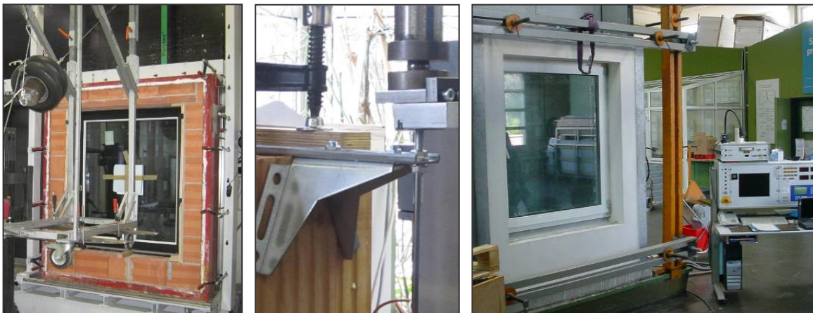
Bild 5 Eignungsprüfung von Montage- und Abdichtungssystemen gemäß ift-Richtlinie MO-01 Teil 1 und 2 (links Stoßbelastung, Mitte Belastung Konsole, rechts Windlast und Schlagregendichtheit)
