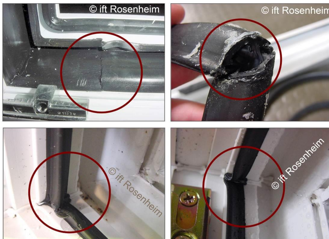
Bild 2 Typische Verarbeitungsfehler und Qualitätsmängel von Fenstern
