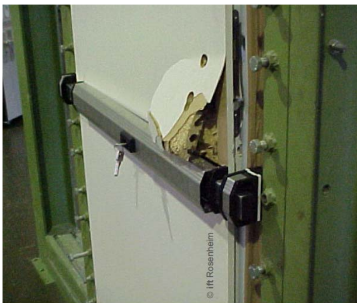
Bild 6 Aufschraubsicherung und Tür müssen aufeinander abgestimmt sein
