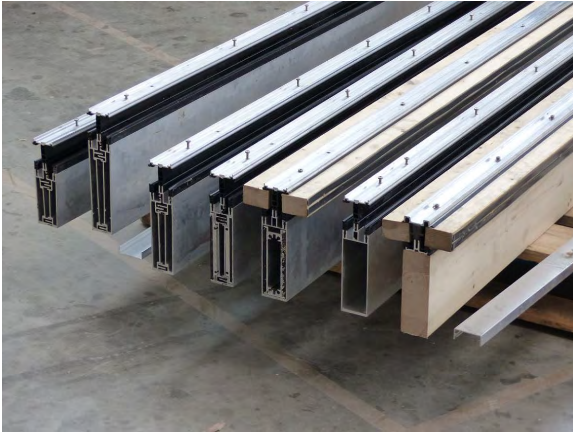
Bild A 20 Foto von Probekörpern für die hier durchgeführten Profilschallmessungen
