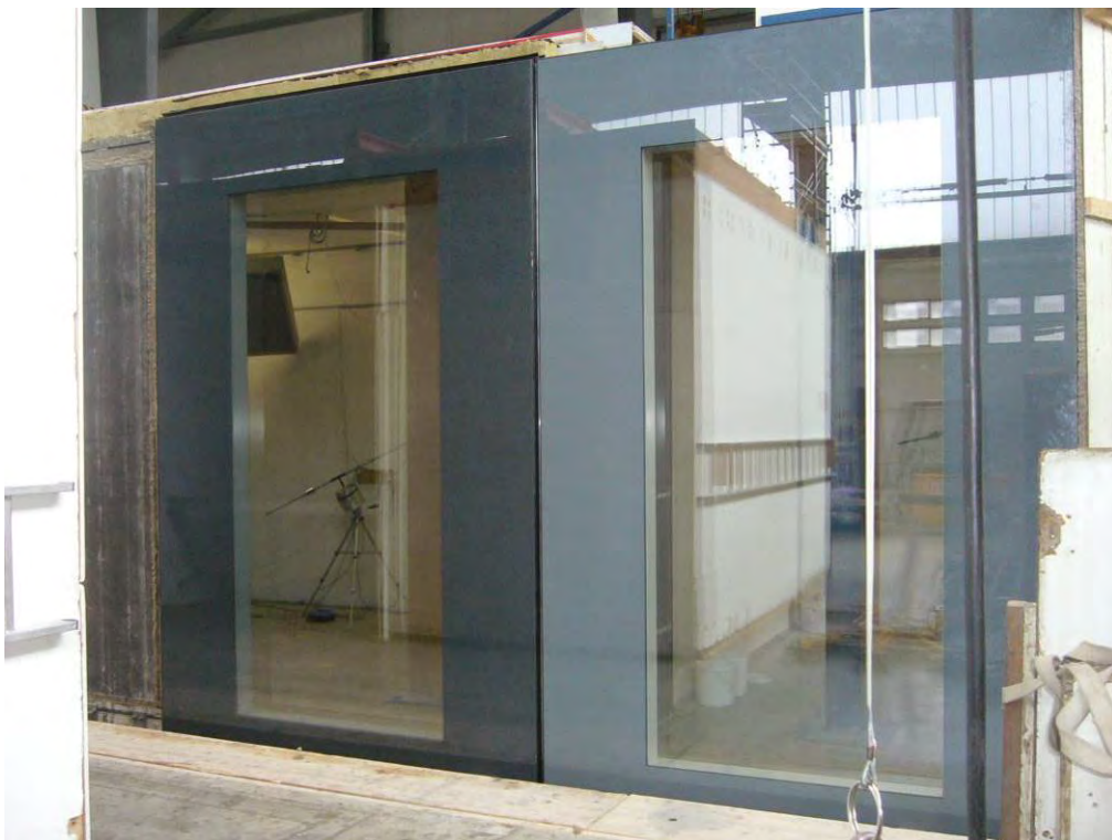
Bild A 15 Beispiel für eine Elementfassade im Großformat (Bildquelle: ift-Vorgang 14-000976)
