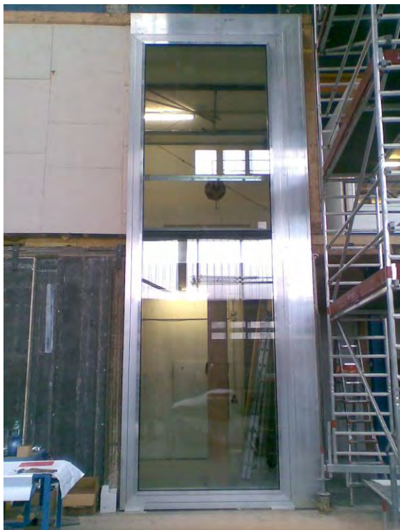
Bild A 13 Beispiel für eine Elementfassade im Großformat (Bildquelle: ift-Vorgang 12-000232)
