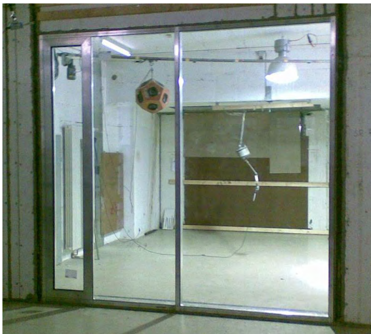
Bild A 9 Beispiel für eine Pfosten-Riegel-Fassade mit Einsetzelement im Großformat, (Bildquelle: ift Vorgang 169 41301)
