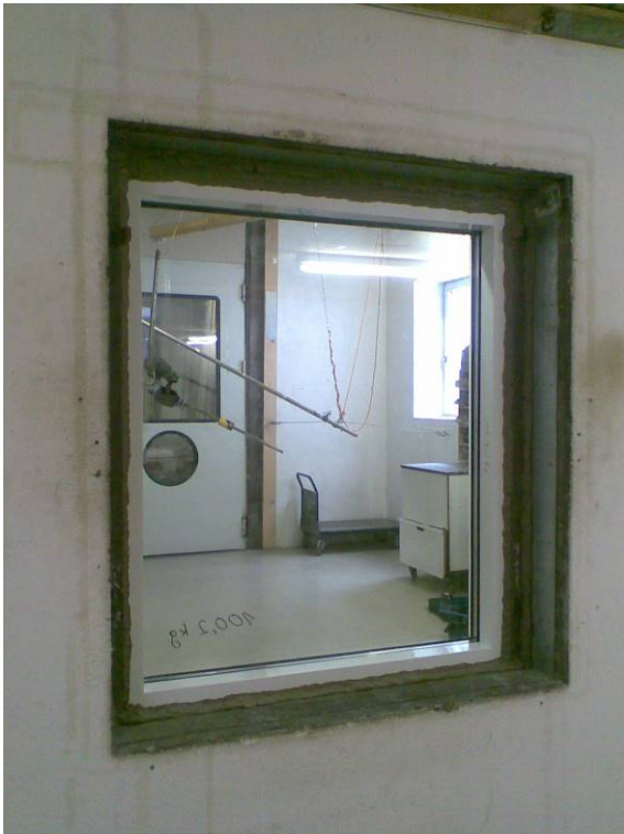
Bild A 1 Beispiel für ein Fassaden-Festfeldelement im Normformat, eingebaut in den Fensterprüfstand nach DIN EN ISO 10140 (Bildquelle: ift-Vorgang 11-003655)
