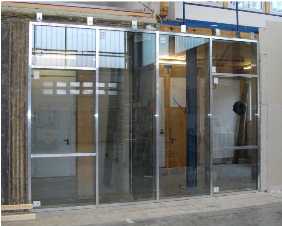
Bild A 6 Beispiel für eine Pfosten-Riegel-Fassade ohne Einselelement im Großformat, (Bildquelle: ift Vorgang 310 45302)
