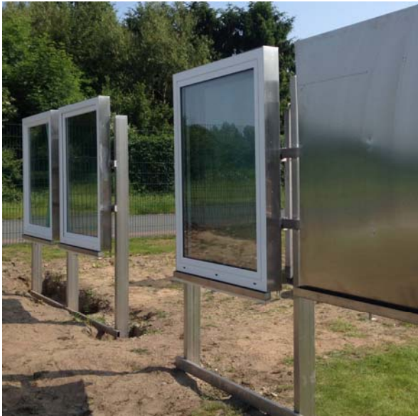
Abbildung 2 Halteschalen mit montierten Fenstern und Prallwand
