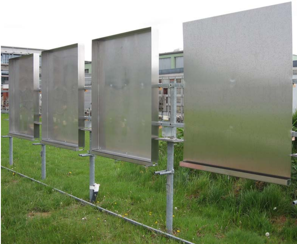
Abbildung 5-2 Montierte Halteschalen und Prallwand Standort Valley
