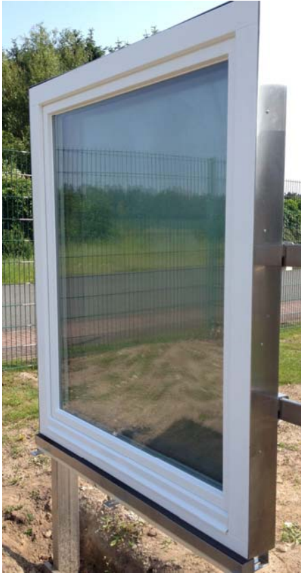
Abbildung 5-4 Detail in Halteschale montiertes Fenster
