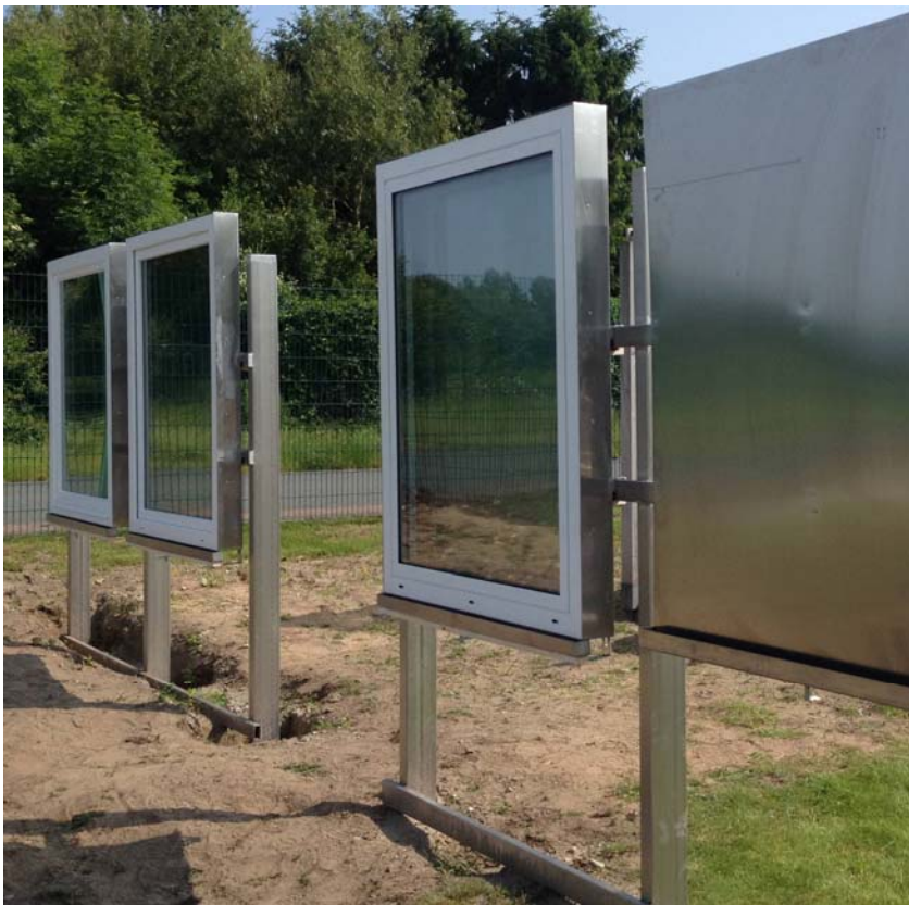
Abbildung 5-3 Halteschalen mit montierten Fenstern und Prallwand Standort Löningen
