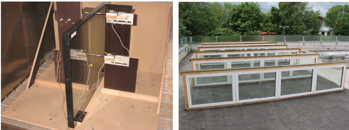
a.) Abbildung 3 a.) MIG-Probekörper mit Wegaufnehmern in der Klimakammer b.) MIG-Probekörper in der Freibewitterung
