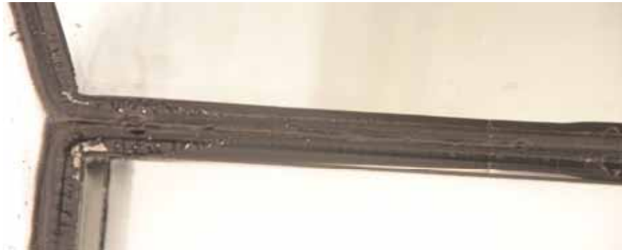
Abbildung 14 Aufgeklappter Probekörper. Unzureichender Butylauftrag in der Ecke und auf der Kante.
