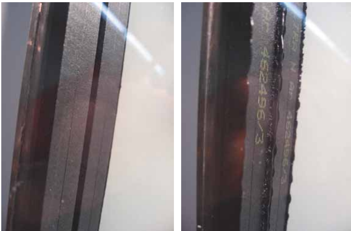
Abbildung 19 Zwei Probekörper vom selben Hersteller: links im Lieferzustand, rechts nach Klimaalterung
