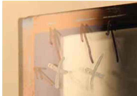
Abbildung 16 Lufteinschlüsse (grau) entlang der dem Sekundärdichtstoff zugewandten Schräge des Abstandhalters; rechts: in Schrägbeleuchtung wird eine unzureichende Randentschichtung sichtbar
