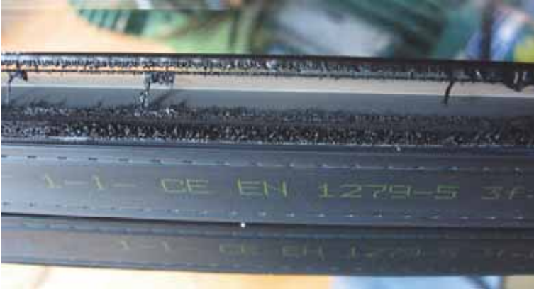
Abbildung 24 Butyl beim Aufklappen überdehnt, alle Fäden gerissen
