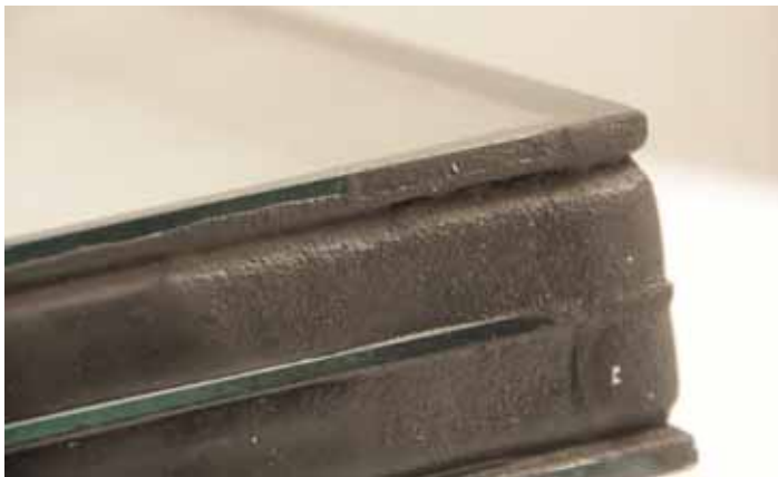
Abbildung 6 Gealterter Probekörper mit Einschnürungen des Randverbundes, Hersteller 13
