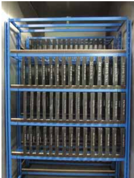
Abbildung 2 MIG-Probekörper auf Regal in Klimakammer
