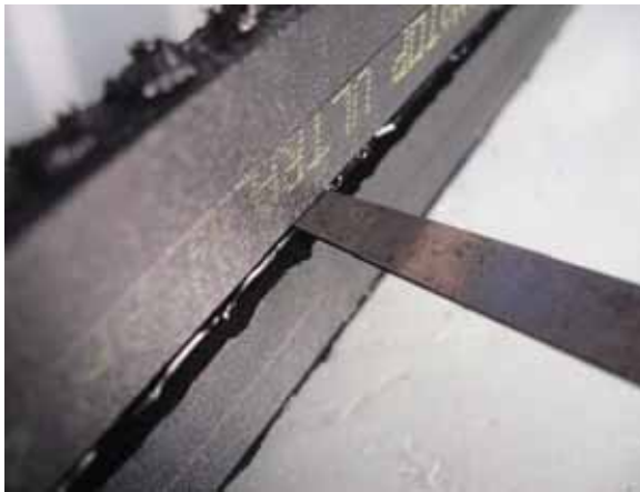
Abbildung 21 Dickensonde (0,3 mm dick, ca. 3 mm eingeführt) in einer Butyldichtung der mittleren Scheibe
