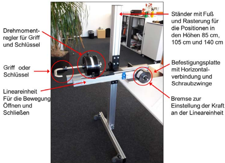
Abbildung 1 Entwickelter Bedienkraftsimulator zur Messung der möglichen Bedienkräfte von Nutzern
