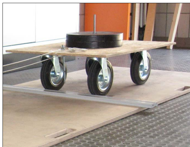
Abbildung 4 Realisierten Rollwagen zum Versuch zur Überrollbarkeit von Schwellen. Zusatzgewicht 40 kg in Plattenmitte fixiert. Position auf der Bewegungsfläche vor der eingebauten Schwelle.
