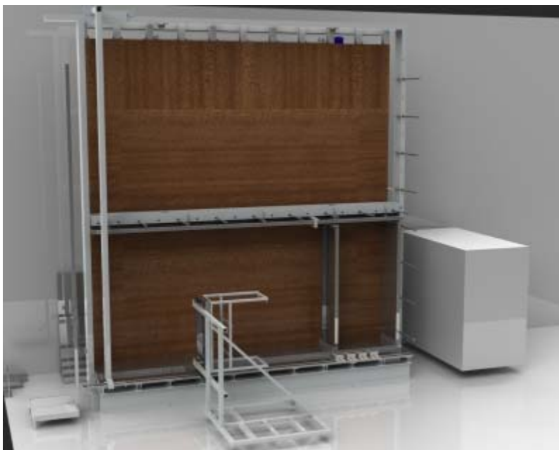
Bild 2 Prüfstand des ift Rosenheim für Fensterprüfungen Luftdurchlässigkeit, Windwiderstandsfähigkeit und Schlagregendichtheit
