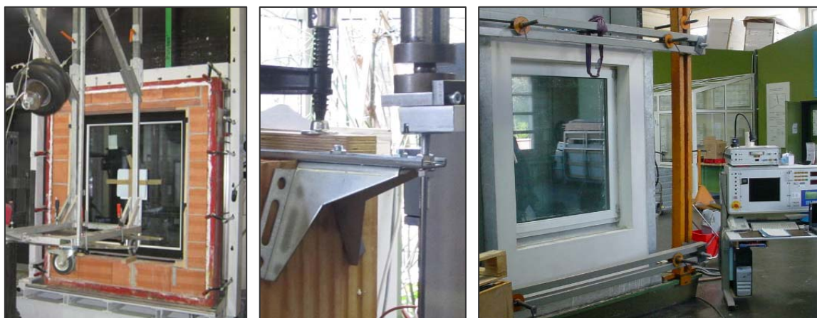
Bild 1 Prüfung von Befestigungs- und Abdichtungssystemen gemäß ift-Richtlinie MO Teil 1 und 2 (links Stoßbelastung, mitte Belastung Konsole, rechts Windlast und Schlagregendichtheit)
