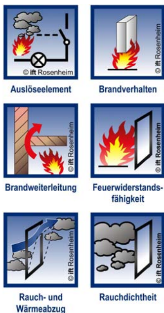
Bild 2 Wichtige Anforderungen an leistungsfähige Brandschutzbauteile
