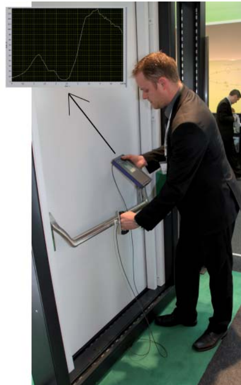
Bild 5 Messung der Freigabekräfte Fotoquelle: © ift Rosenheim MessTec Prüf- und Messtechnik
