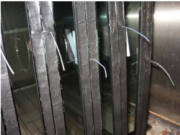
Bild 7 Probekörper mit Kapillaren in der Klimakammer zur Bestimmung der Feuchteaufnahme
