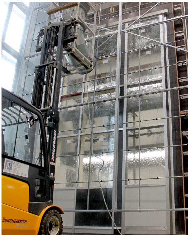
Bild 3 Fassadenprüfstand des ift Rosenheim
