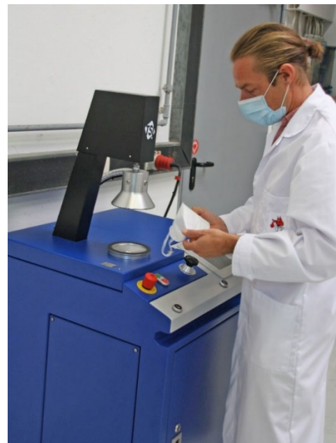
Bild 1 Prüfung der Partikelfilterwirkung einer Maske und Durchlass des Filtermediums gemäß EN 149, EN 405 (Quelle: ift Rosenheim)
