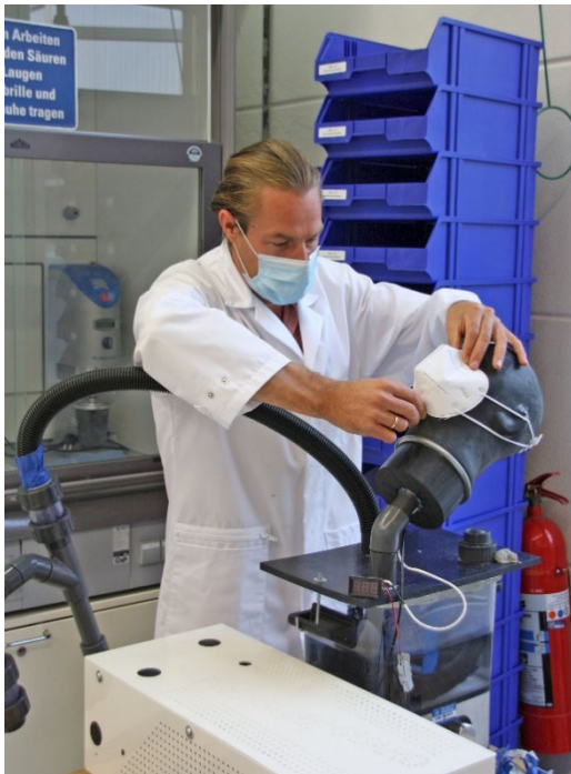
Bild 2 Prüfung der Luftdurchlässigkeit – Atemwiderstand gemäß EN 149, EN 405 und EN 1827 (Quelle: ift Rosenheim)
