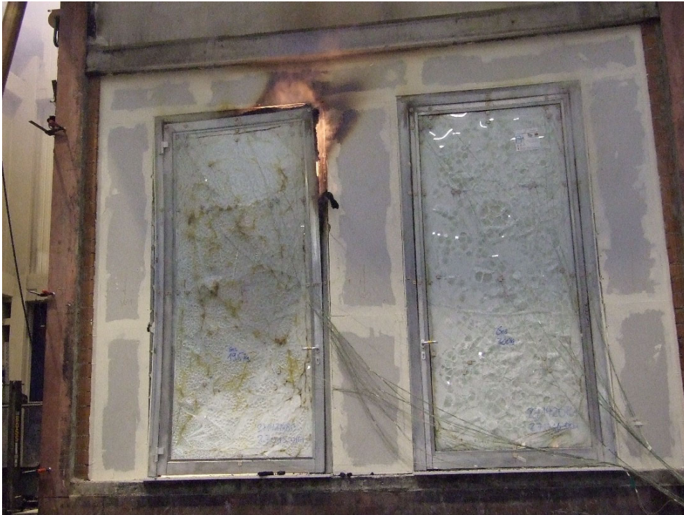
Bild 1 Hinsichtlich der Rauchentwicklung sicher gut: Zwei Feuerschutzabschlüsse in einer Brandprüfung (Quelle: ift Rosenheim)
