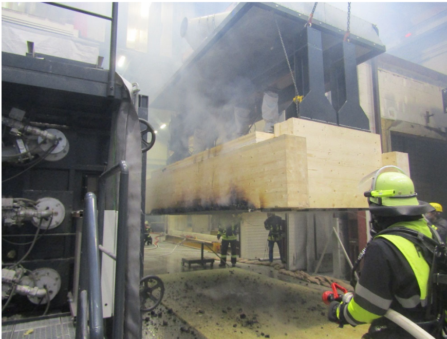
Bild 1 Feuerwehreinsatz nach erfolgreicher Prüfung einer tragenden Holzdecke in Balkenbauweise im Brandlabor des ift-Technologiezentrums
