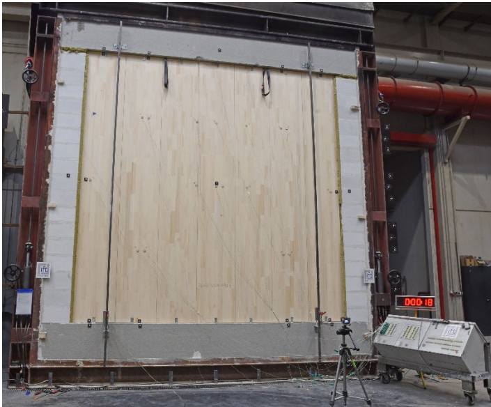
Bild 2 Neue Messeinrichtung am Hydraulikrahmen zur Ermittlung der Stauchung einer tragenden Wand bei der Brandprüfung
