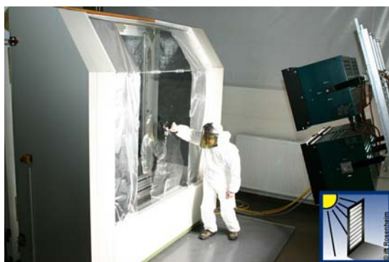
Bild 3 g -Wert-Prüfung komplexer Bauteile mit dem kalorimetrischen Messverfahren
