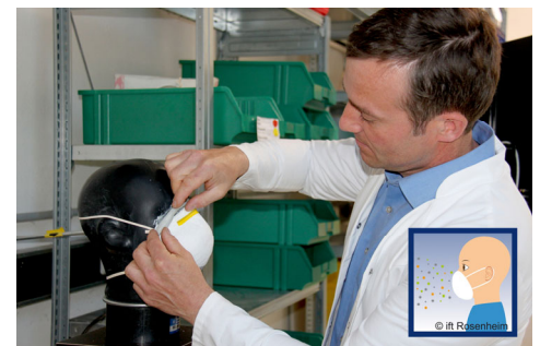
Bild 1 ift-Prüfingenieur beim Anlegen einer Corona-Pandemie-Atemschutzmaske (CPA) am „Prüfkopf“ (mit Piktogramm)
