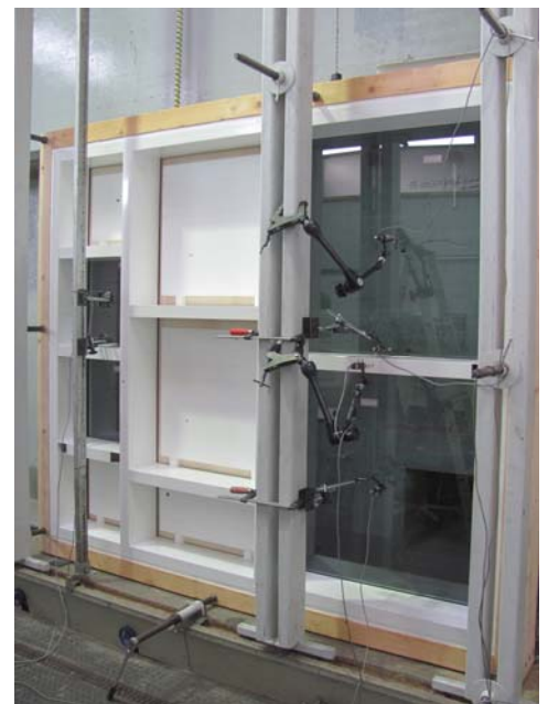
Bild 1 Prüfung von Vakuum-Isolierglas nach ift-Hausverfahren: Künstliche Alterung durch mechanische Belastung
