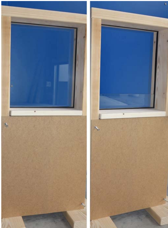
Bild 4 Vertikal-Schiebefenster, bei dem ausschließlich die Vakuumglasscheibe (ohne Flügelrahmen) bewegt wird, in geschlossenem (links) und geöffnetem Zustand
