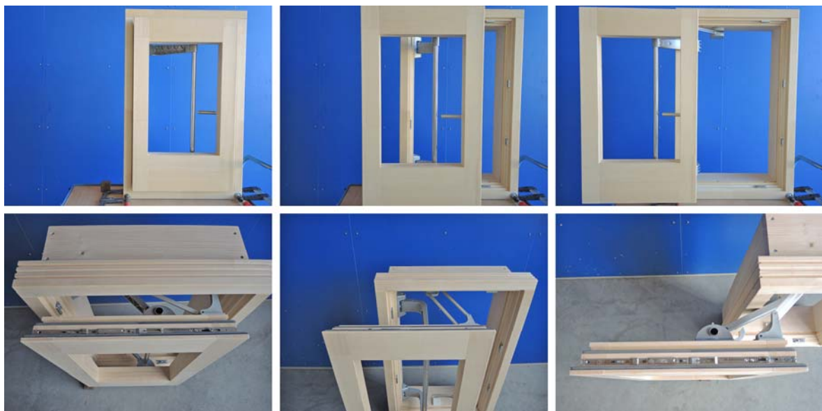
Bild 5 Bewegungsstudie des Dreh-Schwenkfensters mit der Parkposition des geöffneten Flügels außen seitlich an der Wand
