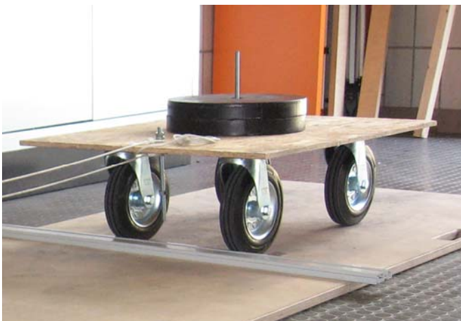
Bild 3 Versuchsaufbau mit Rollwagen zur Ermittlung der Überrollbarkeit von Schwellen
