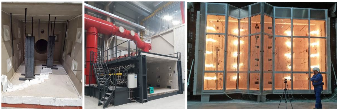
Bild 2 Das ift Rosenheim verfügt über alle Prüfeinrichtungen für den schnellen und effizienten Zugang der notwendigen Nachweise (v.l.n.r Kleinbrandofen, Kombiprüfstand, Ofen 5x8 m)
