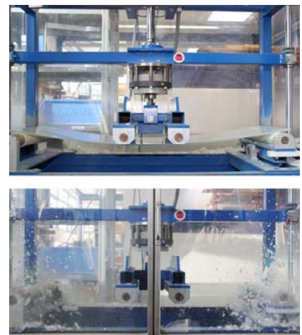
Bild 1 Glasprüfung mit der Biegebruchmaschine auf der Sonderschau Handwerk LIVE in Halle 9
