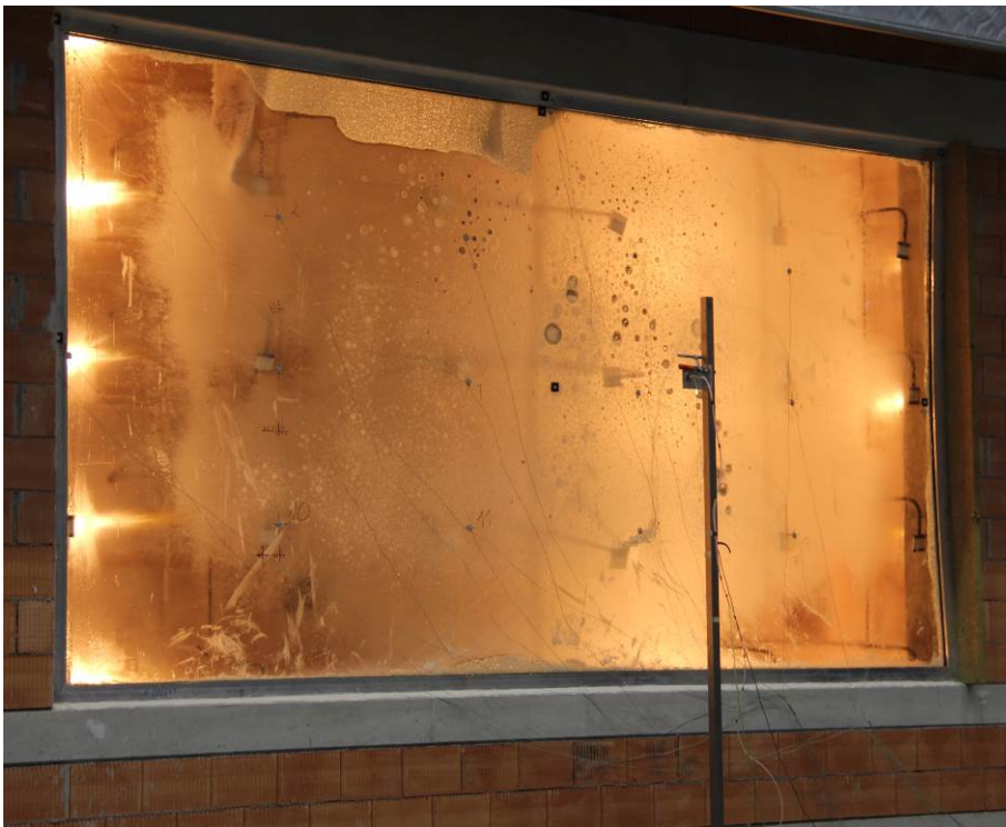
Bild 3 Das zeitlich gleichmäßige Aufschäumen der Schichten einer Brandschutzverglasung zeigt die Temperaturverteilung am Probekörper und ist ein guter Indikator für die Ofenqualität.
