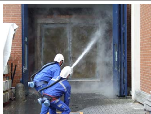
Bild 1 „Hose stream test“ (Wasserstrahl-Prüfung) im Rahmen einer Brandschutzprüfung nach amerikanischem UL-10 Standard
