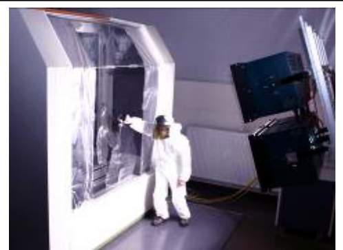
Bild 1 Kalorimetrische Messung innovativer Verglasungen und Fassaden am ift Rosenheim
