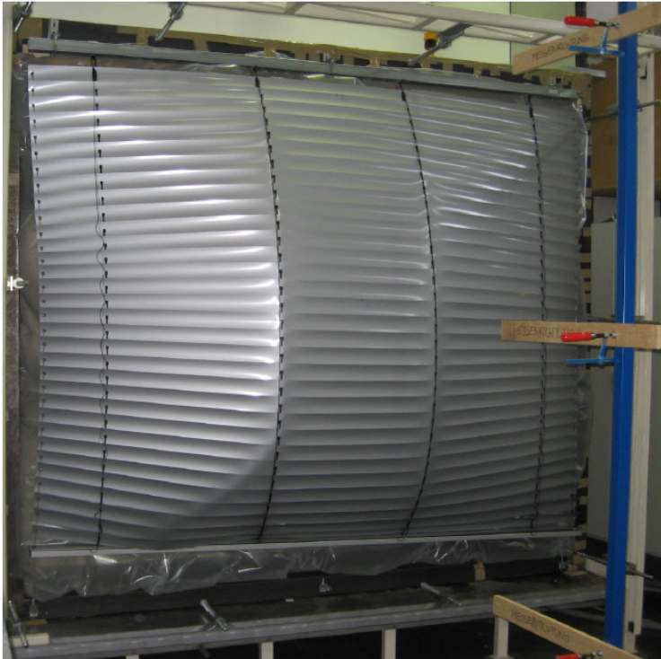
Bild 5 Windlastprüfung an einem Raffstore im ift Rosenheim
