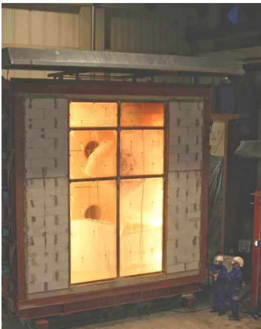
Bild 10 Feuerschutzabschlüsse und Verglasungen können Leben retten und müssen deshalb sorgfältig geprüft und überwacht werden
