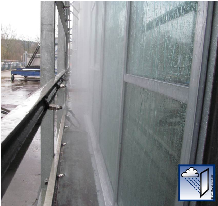
Bild 1 Prüfung der Luft- und Schlagregendichtheit sowie des Windwiderstandes an einem Fassadenelement im ift Prüflabor mit Dokumentation der Kennwerte im ift-Produktpass.
