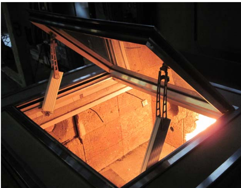
Bild 1 Nach der Prüfung (Brandfall) wird überprüft, ob das NRWG vollständig geöffnet hat.
