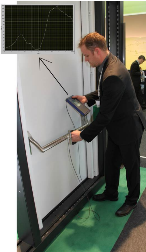
Bild 4 Messung der Freigabekräfte (Quelle: MessTec - Prüf- und Messtechnik ift Rosenheim)
